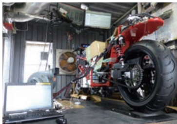
◀シャシダイナモ評価(ブルズアイ) バッテリー性能/モーター制御/電子クラッチ 等、システムの動作チェックを実施。
