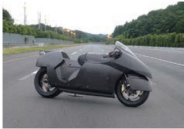
◀高速走行評価(日本自動車研究所) 車両振動に対する対策アイテムの効果 確認を高速周回路にて実施。
