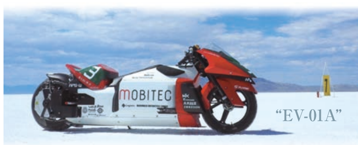
▲カウル変更により、ライダー後方の低速度領域が改善した。
